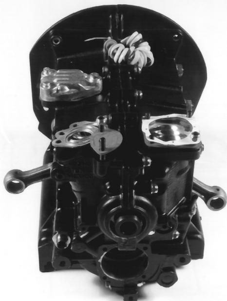
Rumpfmotor ohne Kolben / Zylinder und Zylinderköpfe, ohne Ölpumpe
