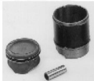
Mit Gusslaufbüchsen, gegossenen Kolben,
